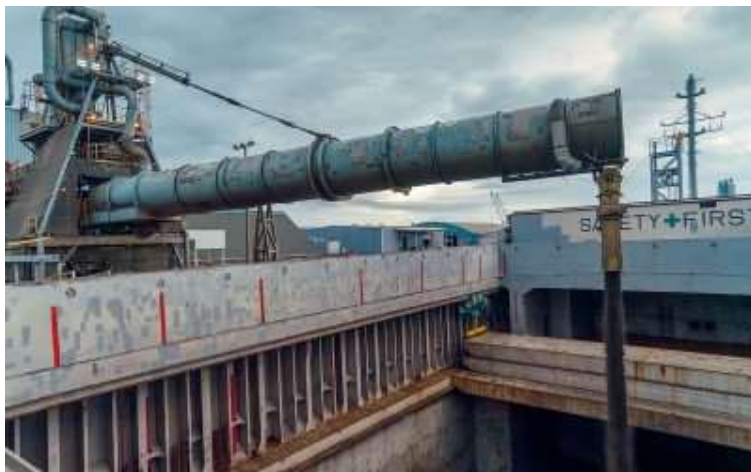
Figure 20 – Terminaux de vrac de Vancouver dans l'État de Washington, chargeur de concentré de cuivre (Source de l'image : https://www.portvanusa.com/news-releases/port-of-vancouver-usa-seeking-west-coast-bulk-facility-operator/ )
